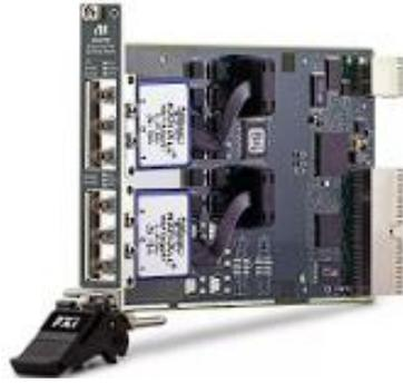
RX38521系PXI总线3U 8组8选1多路复用器模块。继电器选用单刀双掷型。最大切换能力高达60W/62.5VA，最大工作电流可达1A，最大切换电压可达100VDC/100VAC。支持Windows2000/XP/XPe/Vista等操作系统，可广泛用于各种测量和控制领域。
